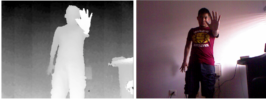
(a) Imagen capturada desde la cámara de profundidad del Kinect. (b) Imagen capturada desde la cámara RGB del Kinect.
